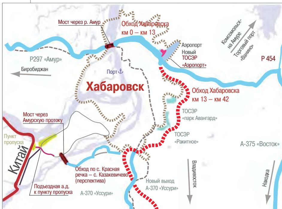
Общая протяженность дороги составит 26,8 км. Проезжая часть шириной 15 м, 4 полосы движения и (впервые в регионе) максимальная разрешенная скорость 120 км/ч позволят пропускать до 25 тыс. автомобилей в сутки. Дорога пройдет через пять транспортных развязок, 24 моста и путепровода. На различных участках будут установлены пять пунктов взимания платы барьерного типа.
